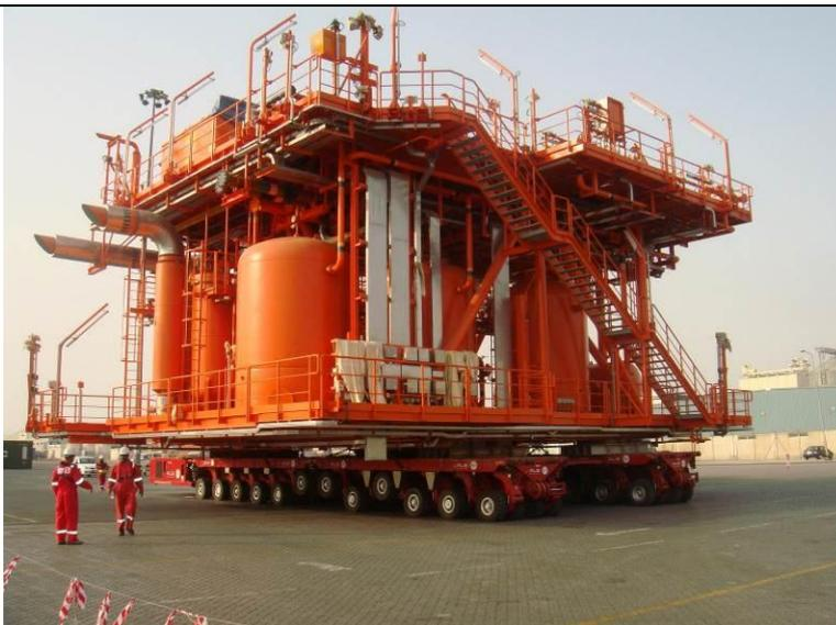
**DESIGN OF STEEL OFF-SHORE MODULES FOR THE REGASIFICATION TERMINAL OLT – FSRU**
